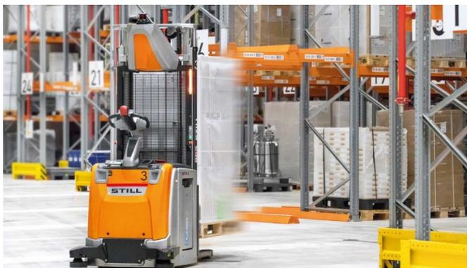
Con una capacidad de elevación de 1.200 kg, la EXV 12 destaca por alcanzar alturas significativas. Es la elección ideal para una manipulación de gran volumen de mercancía de forma rápida y segura.
