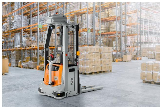
Modelo EXV iGo, un apilador eléctrico fabricado en serie combinado con kit de automatización STILL.
