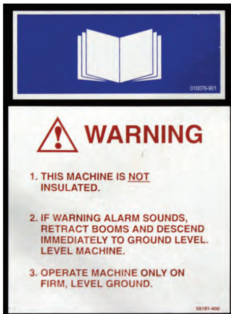
Ilustración 12: señal en plataforma indicando que no tiene propiedades aislantes
