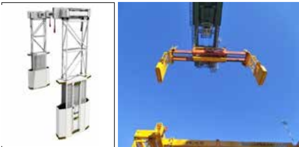
Figura 9. Cesta tipo góndola con un módulo en cada lado del marco principal fijo o telescópico
